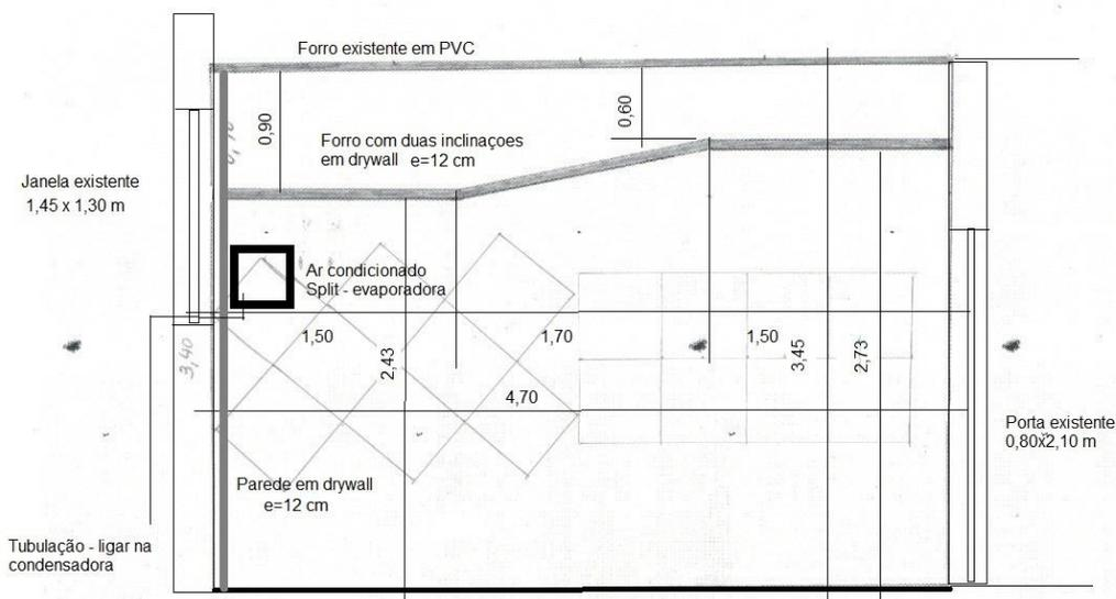
Detalhe de fechamento - forro e parede
